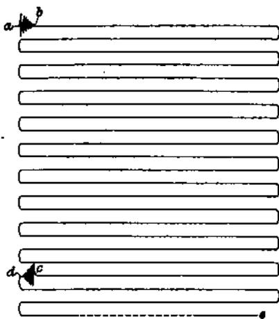
Abb. 14. Diagramm des oszillatorischen Stromverlaufs eines D'Arsonvalapparates.
