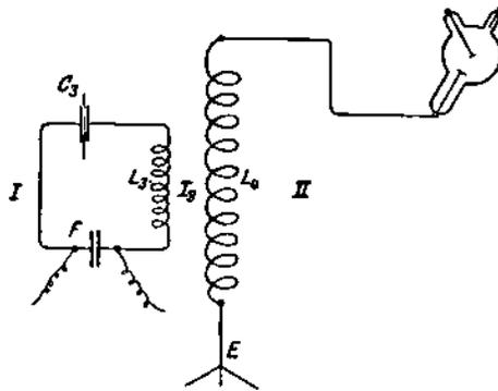
Abb. 25. Schema der Röntgenstrahlenschaltung des Polyfrequenzdiathermieapparates nach Nagelschmidt.
