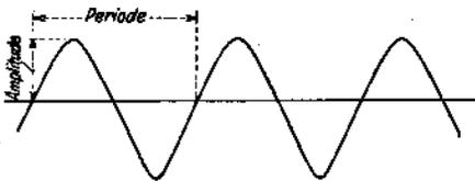
Abb. 3. Sinusoidale Stromkurve.
