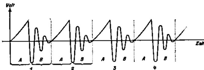
Abb. 20. Spannungsverlauf am Kondensator während einer positiven Phase des primären Wechselstromes. A Ladeperiode. B Schwingungsperiode.
