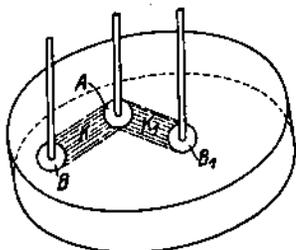
Abb. 45. Schema der Eiweißkoagulation. K: Koagulationszone bei Elektrodenstellung, A B K<sub>1</sub>: Koagulationszone nach Versetzung der einen Elektrode von B nach B<sub>1</sub>.
