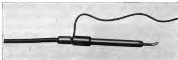
Abb. 67. Chirurgische Metallelektrode, als Thermometer ausgebildet, zur Messung der Temperatur im koagulierten Gewebe.
