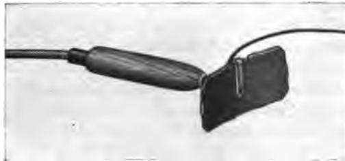
Abb. 65. Hautthermometer zur Verwendung unter einer Plattenelektrode.
