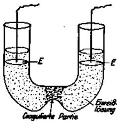
Abb. 46. Mit Eiweißlösung gefülltes Glasrohr. Darstellung der Wirkung der Querschnittsverjüngung.
