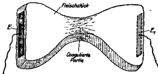
Abb. 47. Querschnittswirkung an einem Fleischstück. Elektrodenfläche größer als der dünnste Querschnitt.
