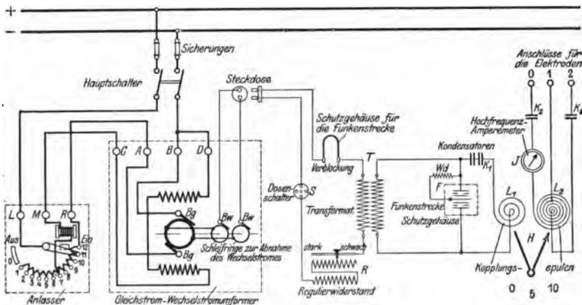
Abb. 17. Siemenscher Diathermieapparat nach Nagelschmidt.
