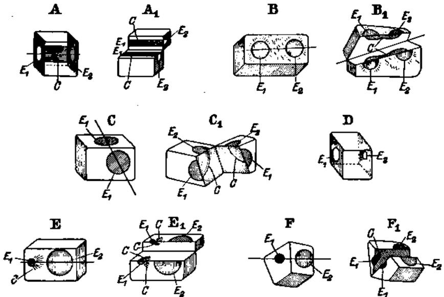
Abb. 43. Schema der Stromverteilung im Gewebe, durch Koagulationszonen (schraffiert) gekennzeichnet.
