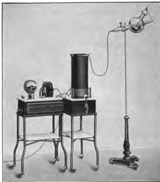
Abb. 26. Anschluß des Instrumentariums für D'Arsonvalisation und Röntgenzwecke an den Siemens'schen Diathermieapparat.
