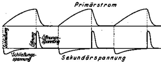
Abb. 2. Stromkurve eines Siemensschen Induktors.
