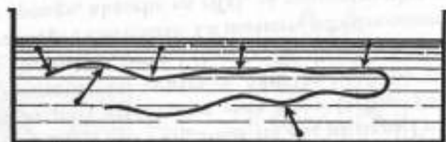
Fig. 8. — Échauffement d'un fil métallique froid plongé dans une cuve d'eau chaude. Les flèches indiquent le trajet des calories qui accourent de l'eau sur le fil pour le mettre en équilibre de température avec le milieu ambiant.
